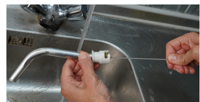
15a| Reinig de tuit met lauw water en de kleine borstel.
