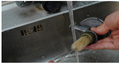
15f| Reinig het pomphuis met behulp van warm water en de grote borstel.
