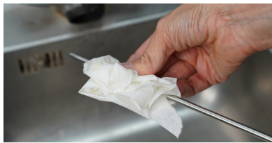
16d| Reinig de ophangstaaf door hem schoon te vegen (indien nodig).
