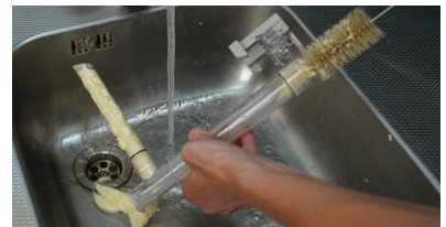
16b| Reinig de prik-/stijgbuis met lauw water met behulp van de grote borstel.
