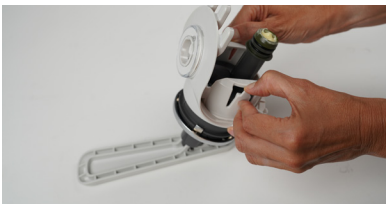
14c| Verwijder het schild door het pompsysteem ondersteboven te houden. Trek de 2 klikvingers naar buiten en het schild komt los.
