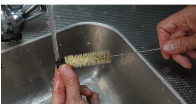
15b| Reinig de nozzle met behulp van de kleine borstel.
