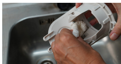
15c| Reinig het schild door het schoon te vegen (indien nodig).
