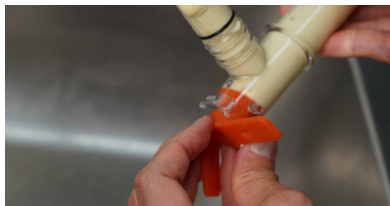
16a| Verwijder het rode buisventiel uit de standbuis.
