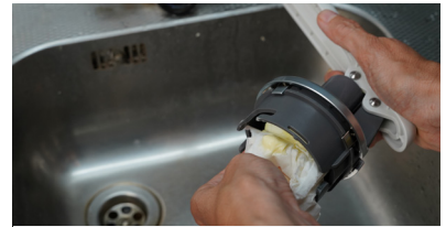
15g| Reinig de zuiger door hem schoon te vegen, terwijl je de hendel ingedrukt houdt.
